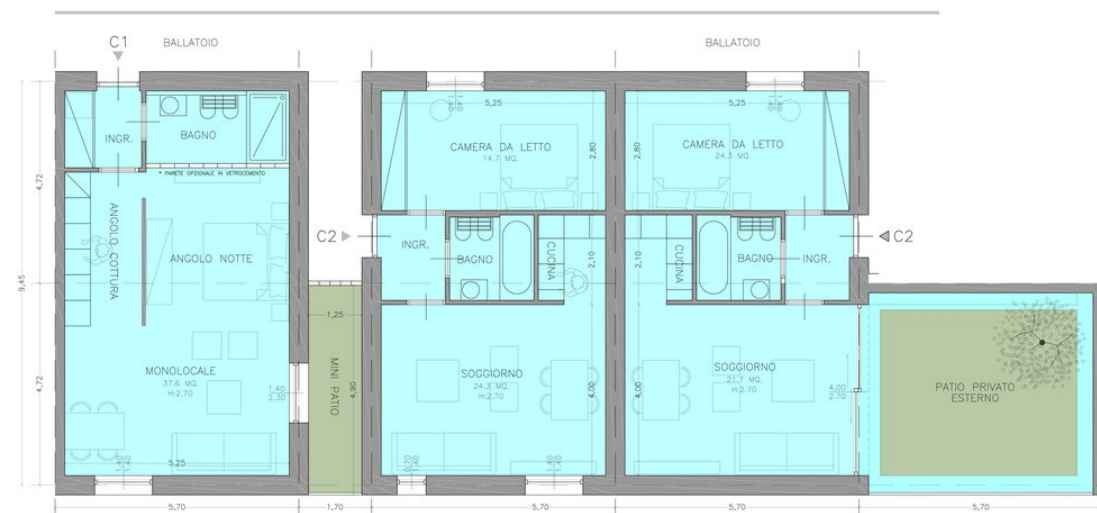
PLANIMETRIE TIPOLOGIA C1, C2 SCALE 1:100
